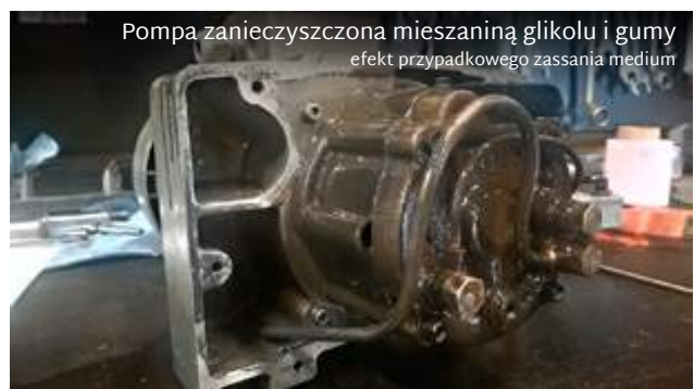
Efekt wykorzystania nieoryginalnych łopatek wnętrze korpusu pompy zniszczonego przez łopatki wykonane metodą chałupniczą
